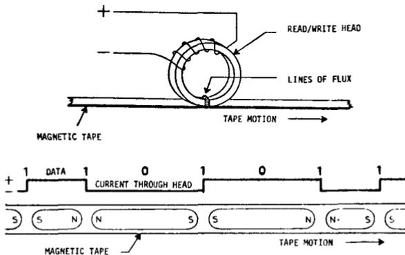
FIGURE 5-17 MAGNETIC TAPE RECORDING
