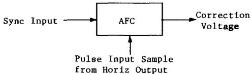
FIGURE 5-8 HORIZONTAL OSCILLATOR AUTOMATIC FREQUENCY CONTROL
