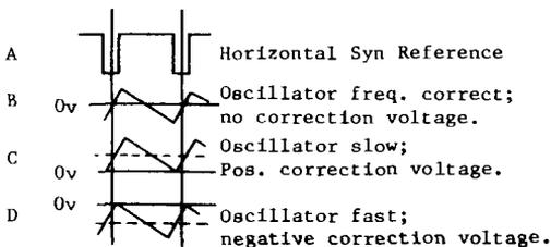
FIGURE 5-9 - HORIZONTAL OSCILLATOR FREQUENCY CORRECTION
