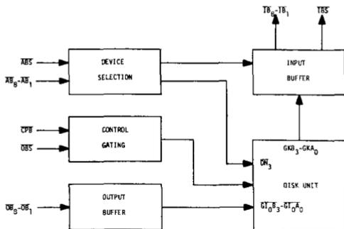
FIGURE 6-1Q DISK CONTROLLER
