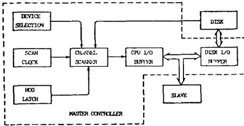
FIGURE 6-11 DISK MULTIPLEXER CONTROLLER
