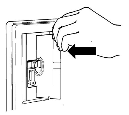
Figure 3-2. Inserting a Diskette
